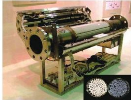
Fotoğraf 2. Fotokatalitik silika jeli (sağda) (soldaki sıradan silika jel) ve dioksin ayrıştırma cihazı
