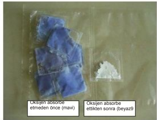
Fotoğraf 7. TiO_2 deoksidan oksijen absorbe etmeden önce (mavi) ve oksijen absorbe ettikten sonra (beyaz).
